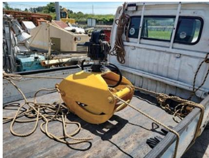
先日は、長野県の蓼科へ重機のパーツを受け取りに行きました。掲載写真のグラップルをバックホーの先に取り付けることで丸太をつかむことができ、丸太を山から運び出したり、トラックに積み込んだりする作業が、今までよりもさらに安全かつ効率的に行えるようになります。軽トラッ
