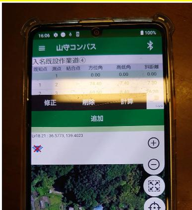
新しい測量システムを導入しました。新しい測量システムは、空中写真を見ながら測量が出来るだけでなく、測量をしていくうちにどのような形になっていくのかがわかります。また、GPS座標で自分のいる場所が大体わかるので、今まで以上に図面を作成しやすくなりました。(田阪)
