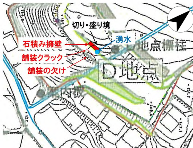
図 5-2-4 D地点旧ゴルフ練習場跡 擁壁毀損状況
